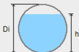
Figur 59: Beregning av kapasitet på eks. overvassleiding, 1000 mm.
