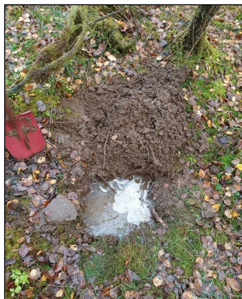
Figur 26. Eksempel på vassig i prøvesticket RH100.
